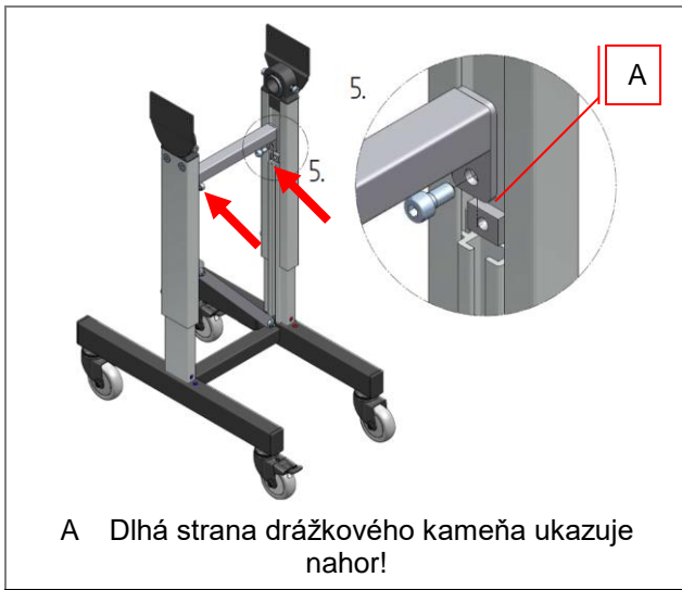
Obr. 34: Montáž podstavca – HE 050/ HM 480
