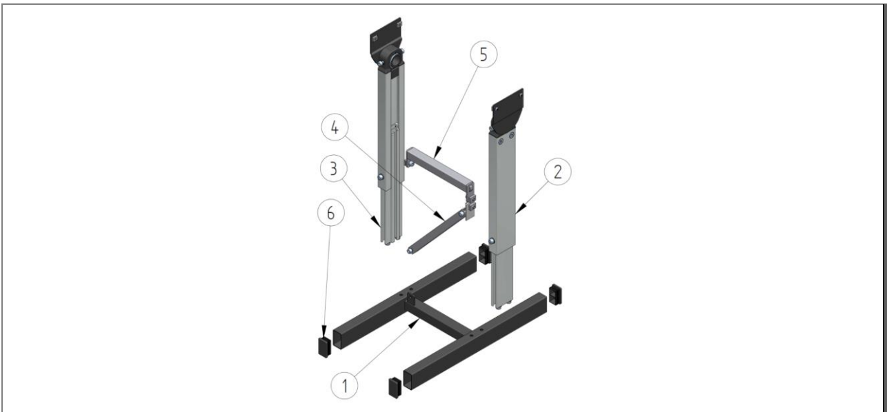
Obr. 99: Kusovník: Podstavec HE 050 - ZZ.982.0080 / HM 480 - ZZ.982.0081
