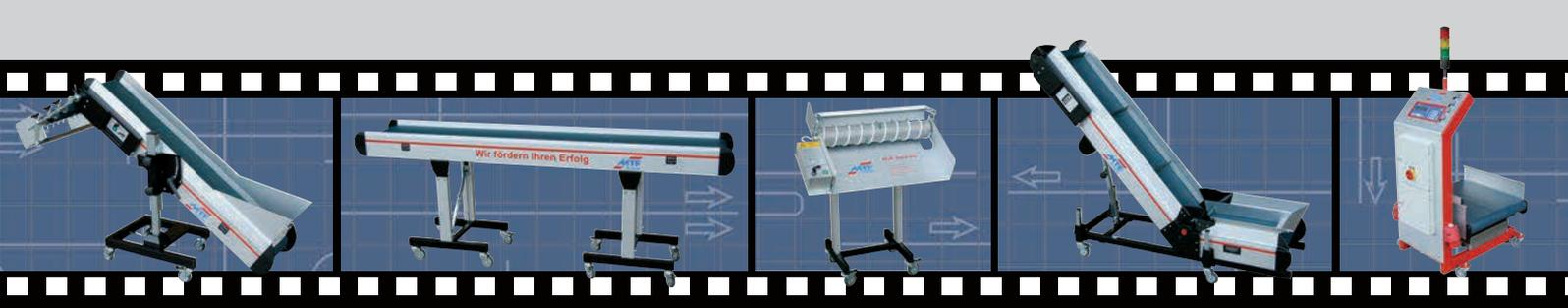
Los **multiseparadores MSL y MSR de MTF** son los dispositivos auxiliares ideales para su producción en tareas que requieran la separación de las piezas moldeadas por inyección y los puntos de inyección. Éstos se emplean cuando hay poco espacio disponible y se requiere un uso flexible en las más diversas máquinas.
