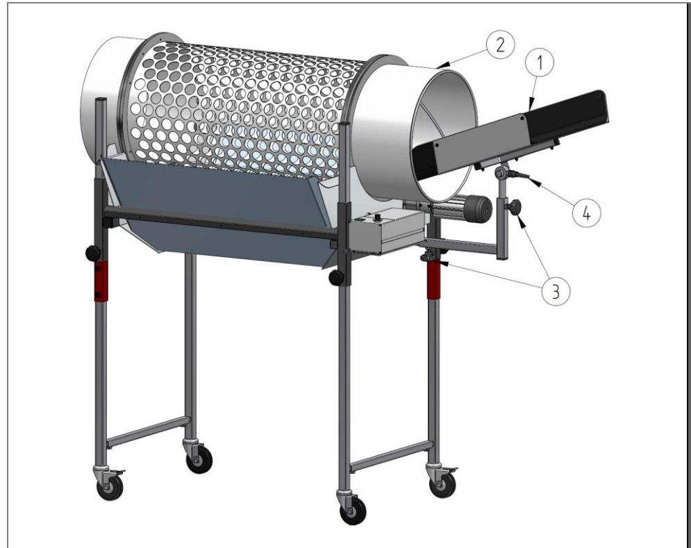
Fig. 10: Posibilidades de ajuste de la tolva de alimentación
