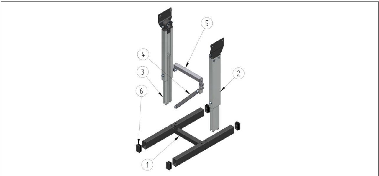
Fig. 99: Lista de piezas: Bastidor inferior HE 050 - ZZ.982.0080 / HM 480 - ZZ.982.0081
