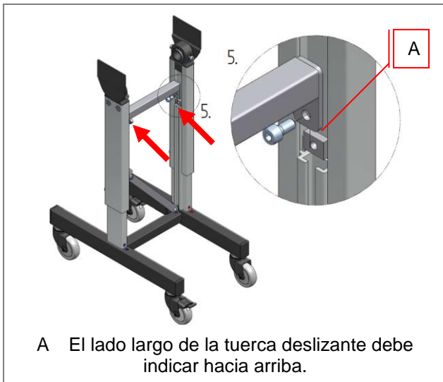
Fig. 34: Montaje del bastidor inferior – HE 050/ HM 480
