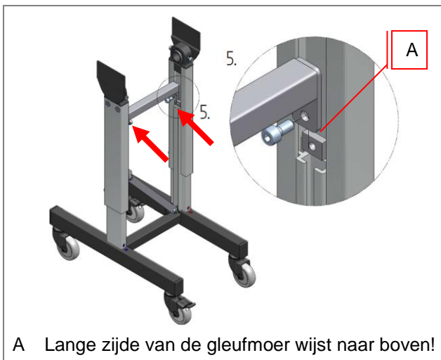
Afb. 34: Montage van het onderstel – HE 050/ HM 480
